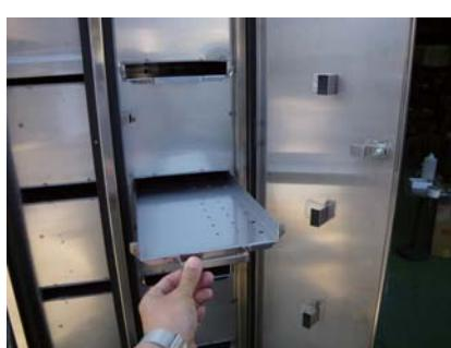
排気用微粉塵捕集装置(微粉塵捕集板)
